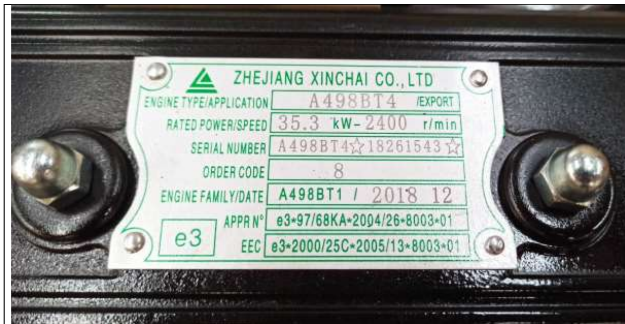
Рис.1-3. Маркировочная табличка двигателя
